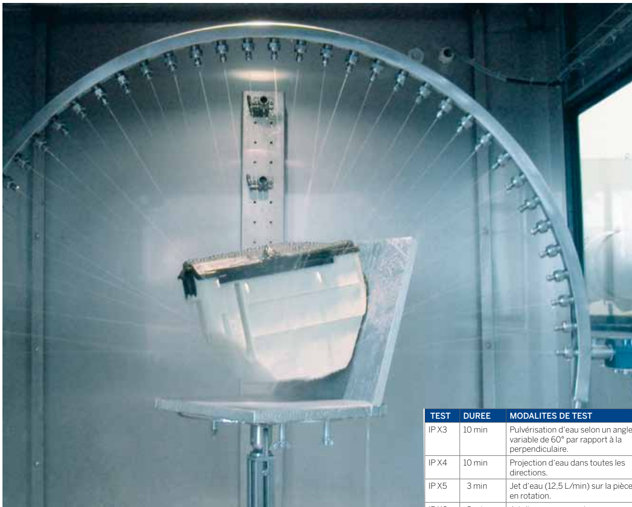
Test en cas de pluie d'un boîtier de commande (Essai IP X3 selon norme DIN 40050) en cabine d'essais
