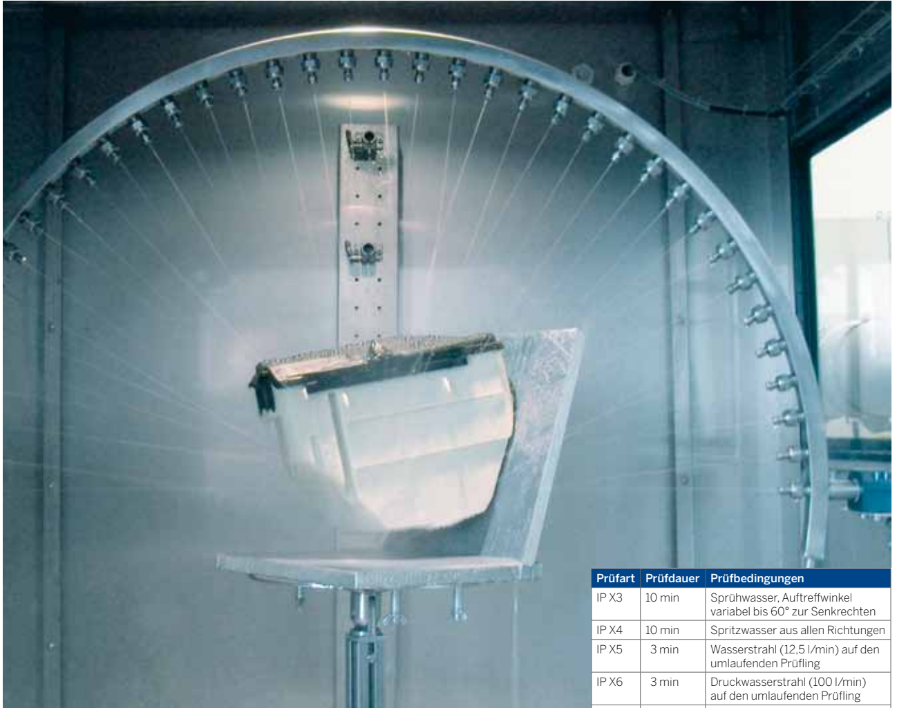
Beregnungsprüfung einer Steuergerätebox (Prüfung IP X3 nach DIN 40050) in der Schutzart-Prüfkammer.
